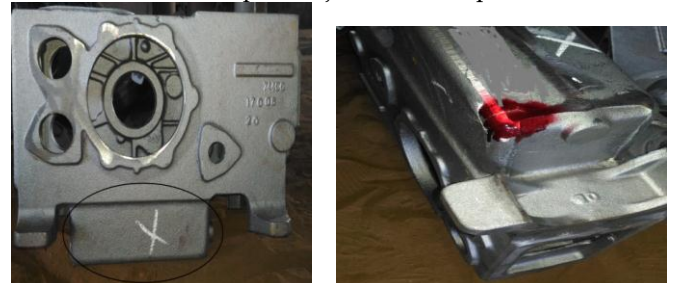
Fig 4:2 Die Penetrant Testing
